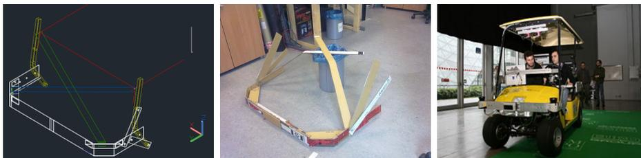
**Figura 4.10:** Le diverse fasi della creazione del sostegno per i LIDAR: creazione CAD del modello (a), prototipo di cartone (b) e struttura finale sul Cart (c)
