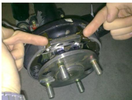
**Figura 4.9:** Il sistema di encoder montato sull'asse delle ruote. Nella figura sono indicati i due emettitori/ricevitori infrarossi che permettono di individuare il movimento della ruota.
