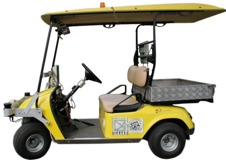
*Figura 4.8:* Il Cart allo stato di sviluppo attuale. Sul frontale la *u-rovesciata* sulla quale sono attaccati i 3 LIDAR.
