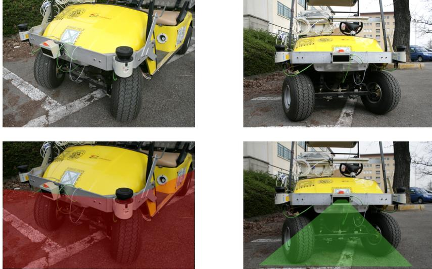
**Figura C.2:** Il posizionamento dei LIDAR sul Cart. In (c) e (d) è stata evidenziata l'area di scansione (per quanto riguarda il sensore a quattro piani è stato indicato il piano inferiore).
